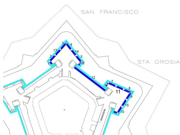
Figura 2. Plano y numeración de los parapetos intervenidos.
